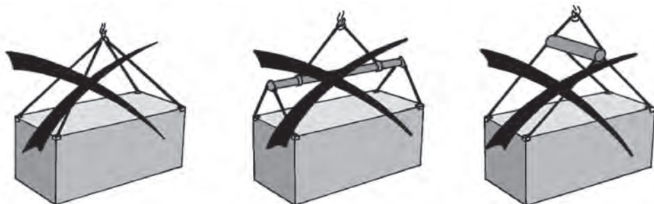
Пример подъема контейнера за четыре крепления в нижних углах
